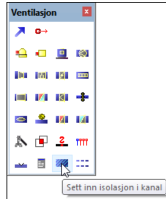
Isolasjon settes i ferdig kanal
